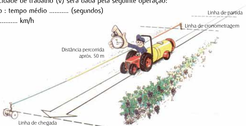
Figura 13 – Determinação da velocidade real (Adaptado de Caliset®. marca registada Syngenta AG, Suíça)
