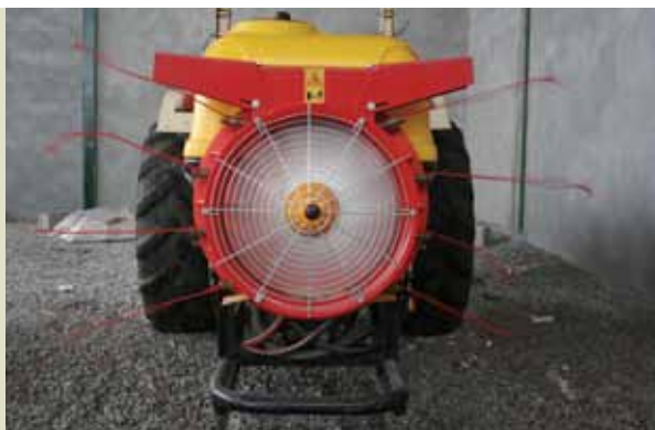
Figura 11 – Regulação do ventilador e orientação dos deflectores e bicos
