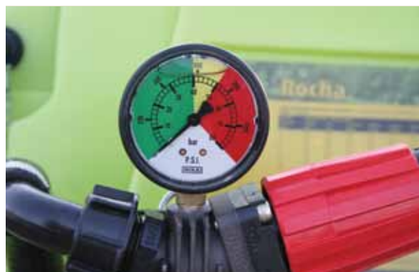
Figura 5 – Manómetro para alta pressão montada no regulador do pulverizador
