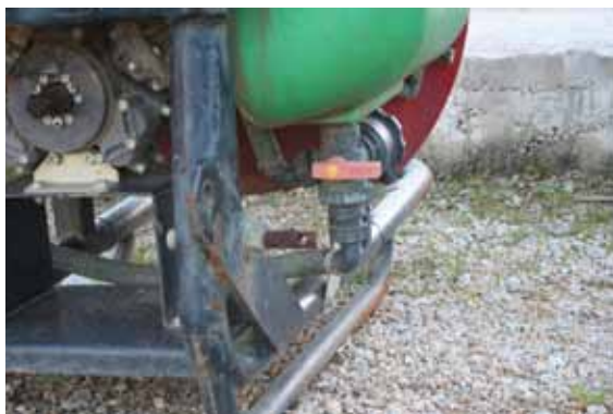
Figura 1 – Pormenor de corrosão no “chassis”
